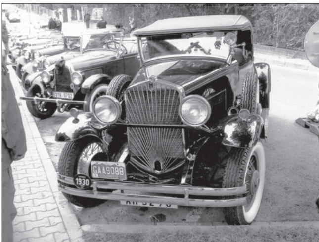
HUPMOBILE mod. S, řad. 6 válec 3,5 l. (USA 1930 – karoserie fy Cleveland-Ranlang) V Evropě 1 ks.
