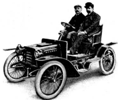
1905. První 2-válec, vodní chlazení, 80 × 100 mm, výkon 6/7 ks.
