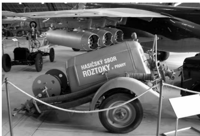
Hasičská stříkačka s motorem AERO 50 – povšimněte si vodou chlazených výfukových kamínek
