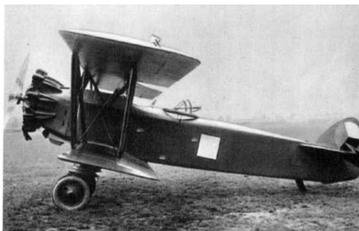
Pozorovací letoun AP 32 s motorem Walter-Jupiter. Výrobek továrny Aero.
