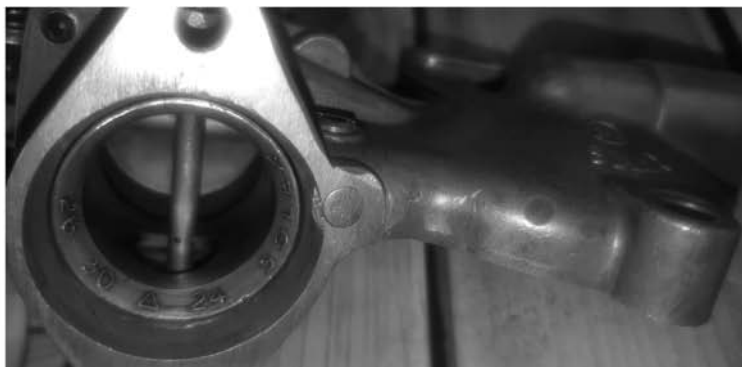
Difuzor vložený do sání karburátoru
