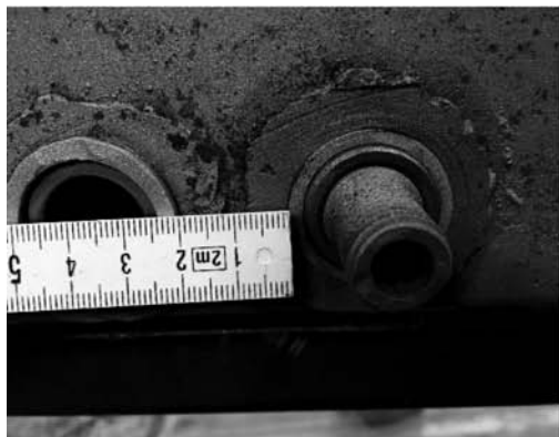
Foto: Souosost zadních čepů & čep před extrakcí a po ní.
