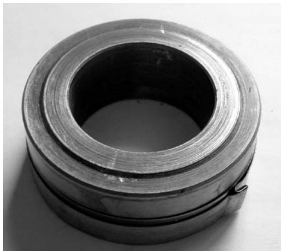
Zadní díl kliky bez kroužku labyrintu ...
