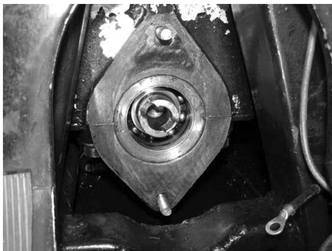
Zadní díl kliky bez kroužku labyrintu ...
