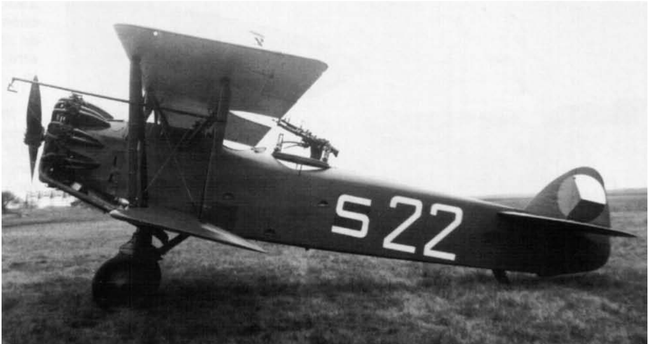
Horní foto: Aero AP-32.20 – vojenský bombardovací a pozorovací letoun z let 1930-31. Motor Walter Jupiter 420 k (309 kW). Dolní foto: Aero AP-32.51 – je variantou předchozího letounu. Obě varianty vycházely z letounu A-32.
