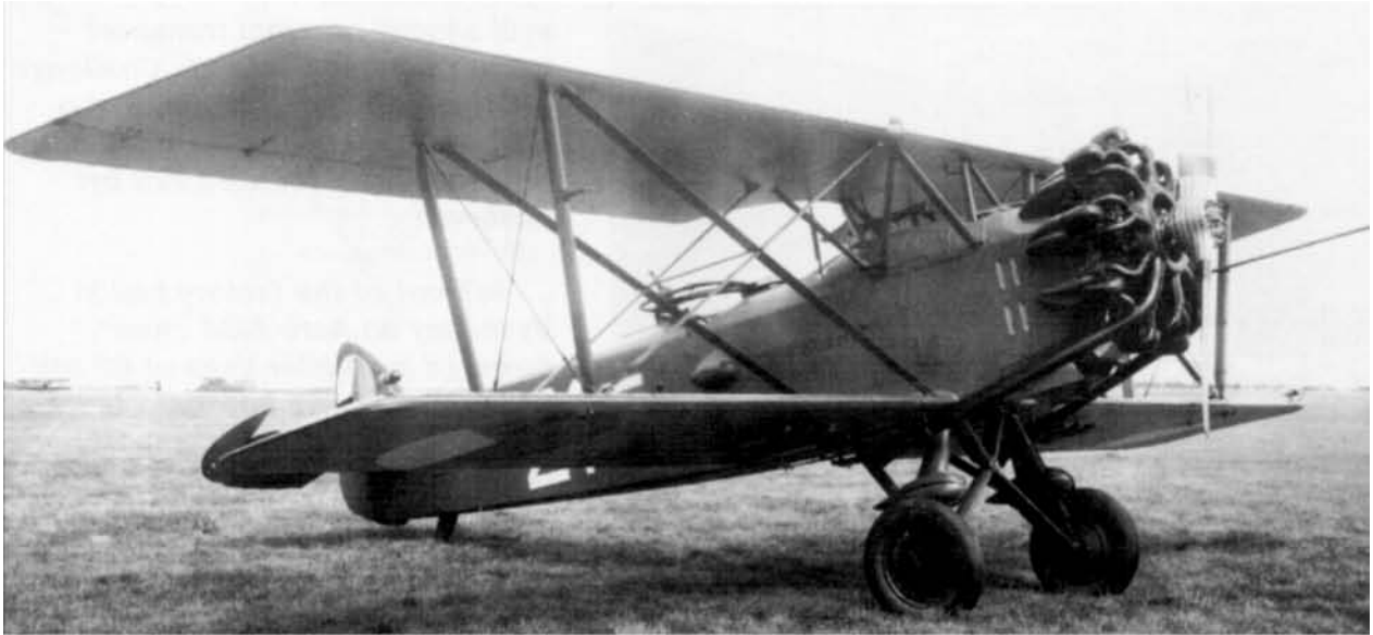
Horní foto: Aero AP-32.20 – vojenský bombardovací a pozorovací letoun z let 1930-31. Motor Walter Jupiter 420 k (309 kW). Dolní foto: Aero AP-32.51 – je variantou předchozího letounu. Obě varianty vycházely z letounu A-32.
